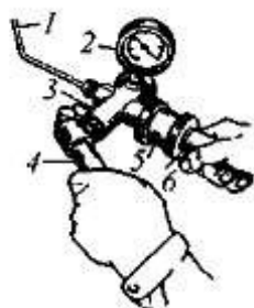
1 - топливопровод; 2 - манометр; 3 - насос; 4 - рычаг насоса; 5 - корпус; 6 - рукоятка
